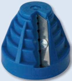
Die VOTEC Ansträgglöcke ist ein innovatives und hochwertiges Werkzeug für das sichere Anfasen von PE-Rohren in den Nennweiten von 20 bis 110 mm Durchmesser. Mit einer perfekten Fase können Rohrleitungen sicher in Formteile und Fittings eingeführt werden, ohne deren innenliegende Dichtungs- und Verbindungstechnik mit einer scharfen Kante zu beschädigen.
