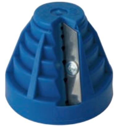
Die VOTEC Anschlägglocke ist ein innovatives und hochwertiges Werkzeug für das sichere Anfasen von PE-Rohren in den Nennweiten von 20 bis 110 mm Durchmesser. Mit einer perfekten Fase können Rohrleitungen sicher in Formteile und Fittings eingeführt werden, ohne deren innenliegende Dichtungs- und Verbindungstechnik mit einer scharfen Kante zu beschädigen.
