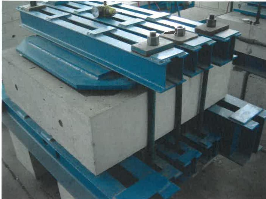
Bild 5: Im Beton eingebundener VOTEC Mauerkragen während der Dichtigkeitsprüfung
