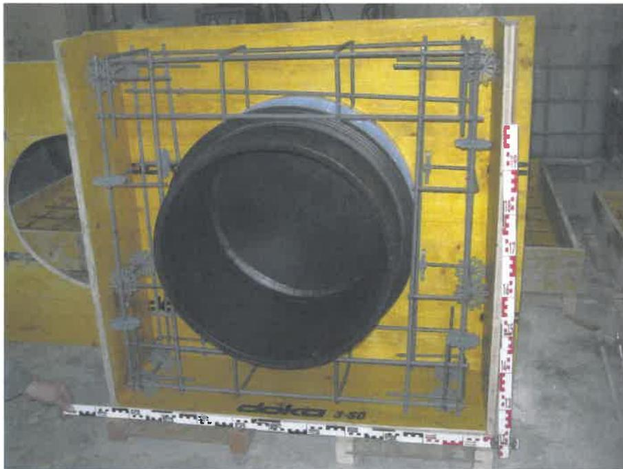
Bild 4: Einbau des Prüfkörpers in die Schalung
